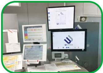
4つのモニターで常に印刷不良を監視
